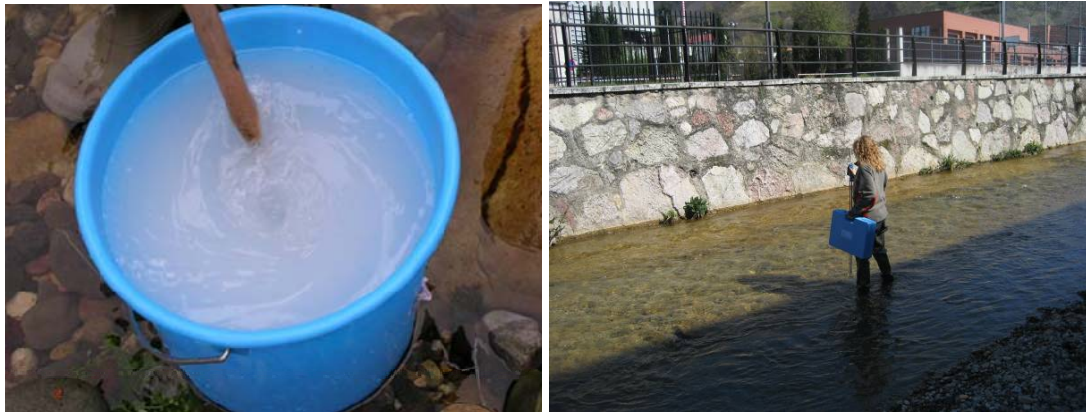
Fotografía 10-2.- Aforo químico: a) Preparación del trazador (NaCl); b) Proceso de medida
